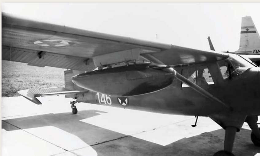
Подвесник са два мишрањеца калибра 7,62 мм МАЦ АА 52 на пошкринлом носачу В-51 (Фото: ВОЦ)
